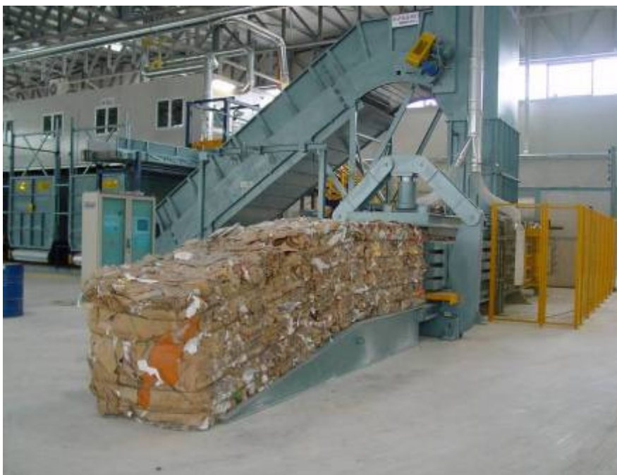
Fig. 10 – La pressa ed il rifiuto imballato in uscita da essa.
