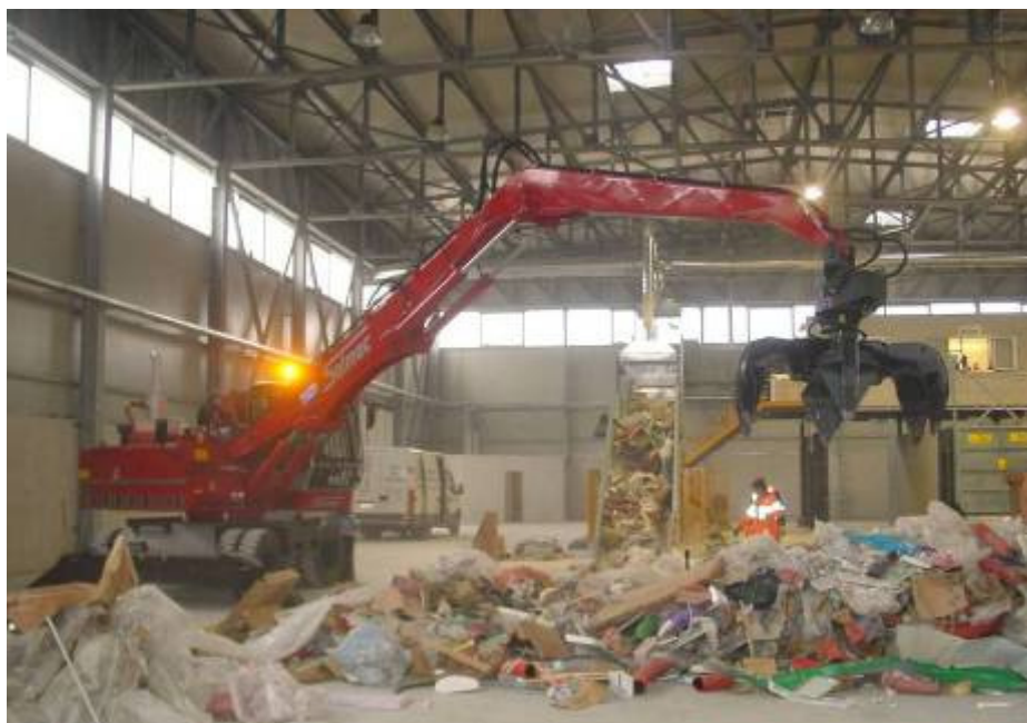
Fig. 8 – Interno dell'impianto di cernita e valorizzazione con particolare del ragno che carica il rifiuto sul nastro trasportatore.
